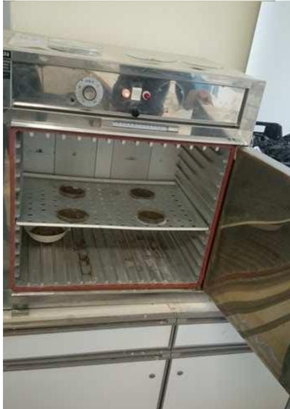
Φωτ. 6: Φούρνος αποξήρανσης: Συμβάλει στην απομάκρυνση της υγρασίας από το δείγμα. Στη συγκεκριμένη περίπτωση τα ενεργοποιημένα δείγματα από παλυγορσική τοποθετήθηκαν στο φούρνο και αφέθηκαν για ένα εικοσιτετράωρο στους 55°C.
