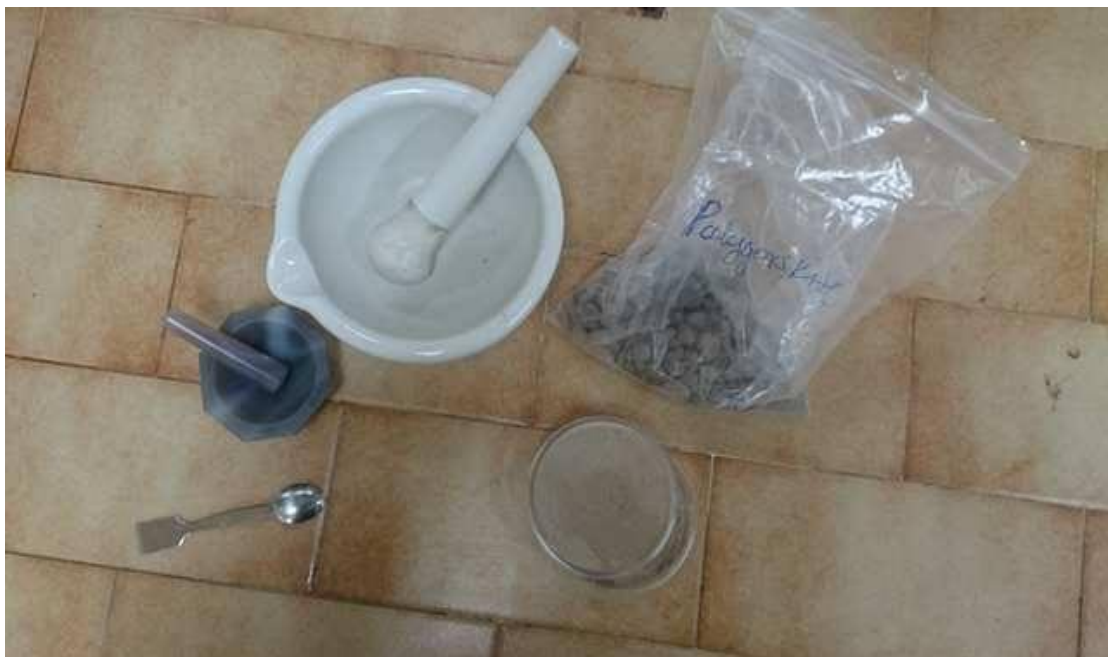
Φωτ. 1: Γουδί και γουδοχέρι: Κατασκευασμένα από αχάτη. Χρησιμοποιούνται για την κονιορτοποίηση, θρυμματισμό του υλικού, στη περίπτωση μας παλυγορσκήτη.
