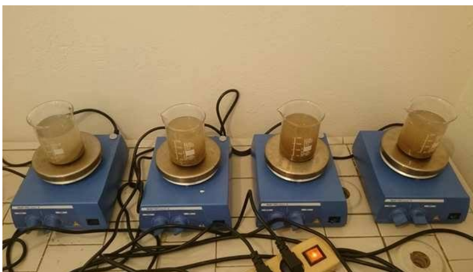
Φωτ. 3: Θερμαινόμενοι μαγνητικοί αναδευτήρες: Χρησιμοποιούνται για την ομογενοποίηση διαλυμάτων. Η θερμική εστία που συμπεριλαμβάνουν οδηγεί σε ακόμα καλύτερα αποτελέσματα.
