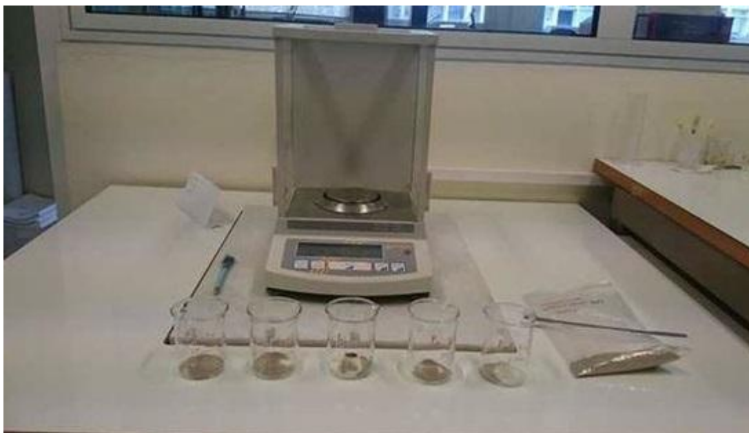
Φωτ. 2: Ζυγός ακριβείας: Παρέχει υψηλή ακρίβεια στη μέτρηση του βάρους του εκάστοτε δείγματος.
