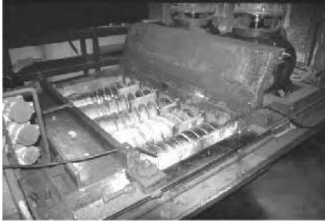
Εικ. 1.5: Περιστρεφόμενες αρίδες(augers) προκαλούν δυναμική εξώθηση στο σκυροδέμα. (Πηγή: “PRECAST CONCRETE STRUCTURES”, Kim S. Eliot)
