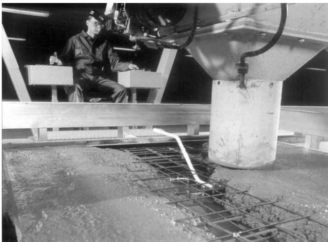
Εικ. 1.1: Ακριβής διανομή του σκυροδέματος σε τύπο. (Πηγή: “PRECAST CONCRETE STRUCTURES”, Kim S. Eliot)
