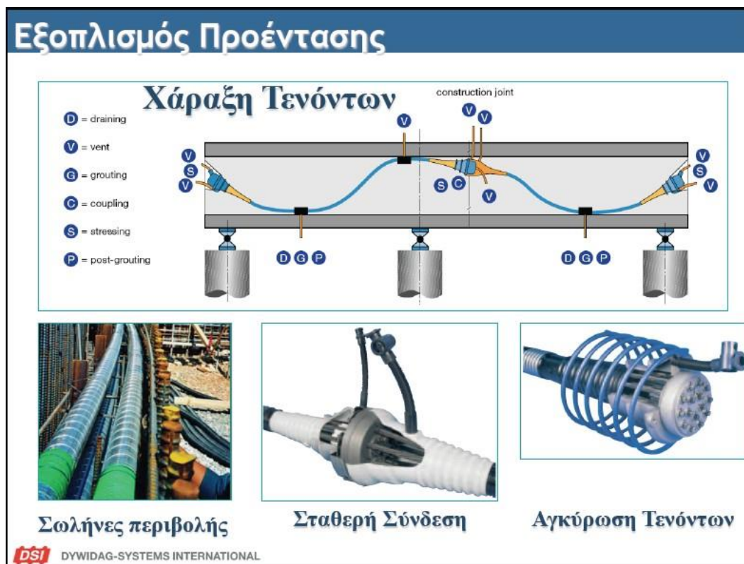
Εικ. 3.1: Εξοπλισμός προέντασης. (Πηγή: “ΠΡΟΕΝΤΕΤΑΜΕΝΟ ΣΚΥΡΟΔΕΜΑ”, Ε. Μπούσιας, Τμήμα Πολιτικών Μηχανικών-Εργαστήριο Κατασκευών)
