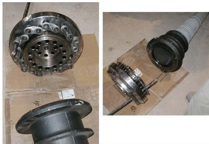
Εικ. 3.10: Πλάκα αγκύρωσης. (Πηγή: “ΠΡΟΕΝΤΕΤΑΜΕΝΟ ΣΚΥΡΟΔΕΜΑ”, Ε. Μπούσιας, Τμήμα Πολιτικών Μηχανικών-Εργαστήριο Κατασκευών)
