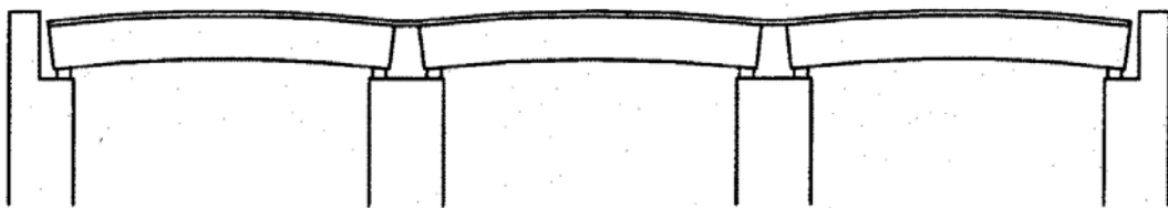
Εικ. 6.2: Ατέλειες διαμήκους προφίλ διατομής γέφυρας λόγω καμπυλότητας των ανεξάρτητων προφορτισμένων(δοκών) ανοιγμάτων γέφυρας. (Πηγή: “PRECAST CONCRETE BRIDGES”, state-of-art-report, fib ceb-fip (bulletin 29))
