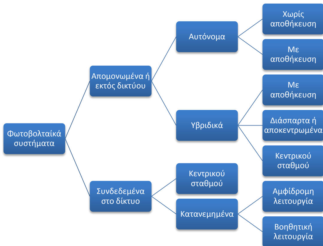
Εικόνα 4 Κατηγορίες φωτοβολταϊκών συστημάτων
