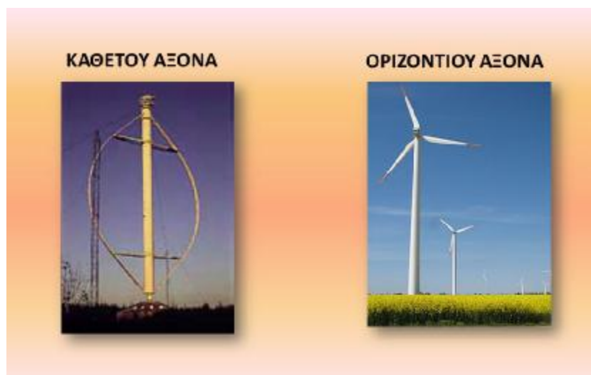
Εικόνα 3.1: Ανεμογεννήτριες καθέτου και οριζοντίου άξονα
