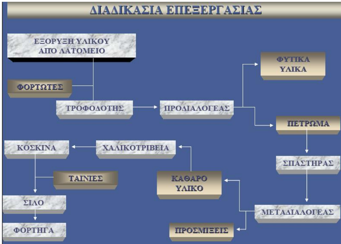
Διάγραμμα 1: Διαδικασία επεξεργασίας μεταλλεύματος σε λατομείο
