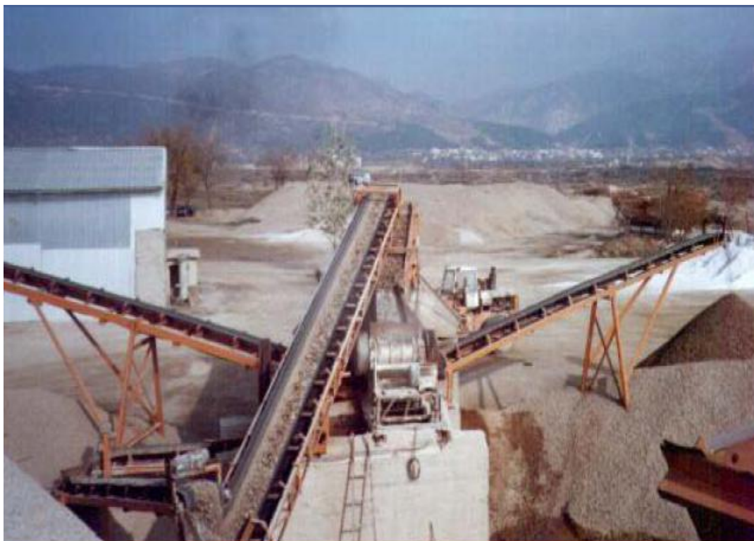
Εικόνα 3: Ταινιόδρομοι σε λατομείο
