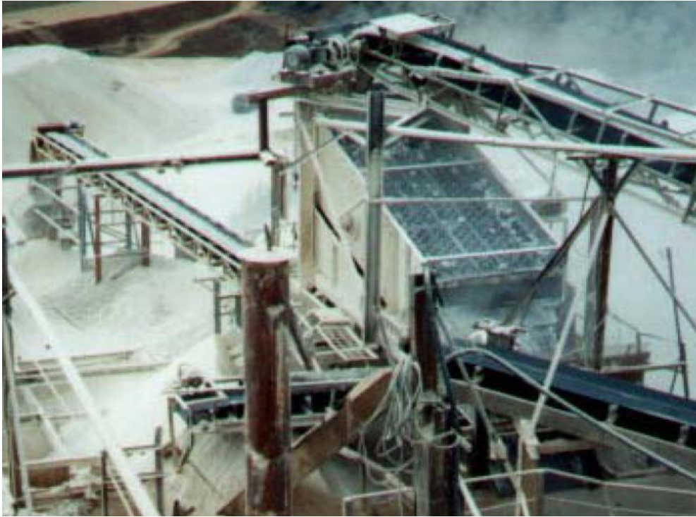
Εικόνα 2: Κόσκινο σε λατομείο
