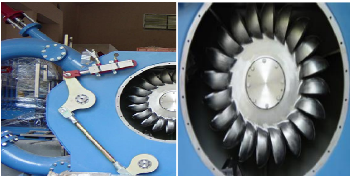
Εικόνα 12: Ολόσωμο χυτό στροφέιο στροβίλου Pelton
