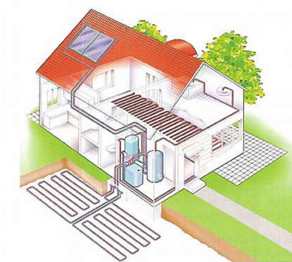
Εικόνα 23:Εγκατάσταση παθητικού ηλιακού συστήματος
