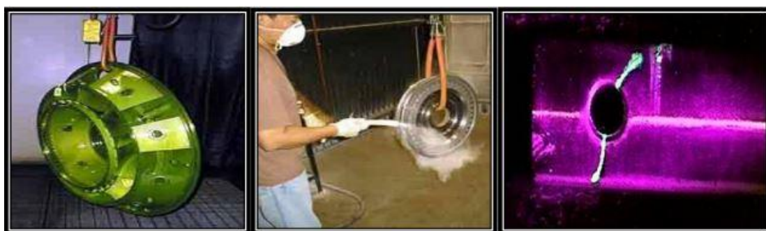
Σχήμα 0.03: Στάδια Μεθόδου Εντοπισμού Σφαλμάτων με Χρήση Διεισδυτικών Υγρών
