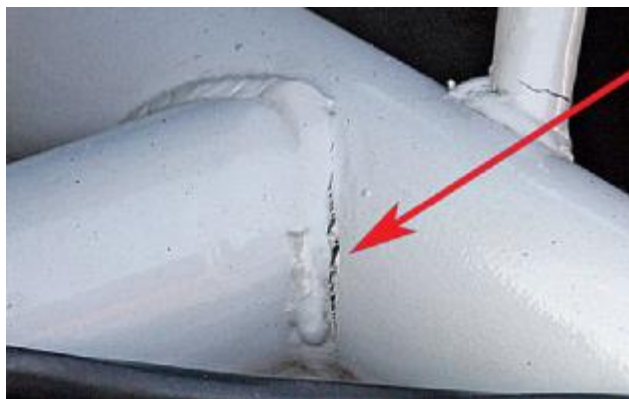
Σχήμα 0.01: Ρήγμα σε κόλληση σκελετού αυτοκινήτου
