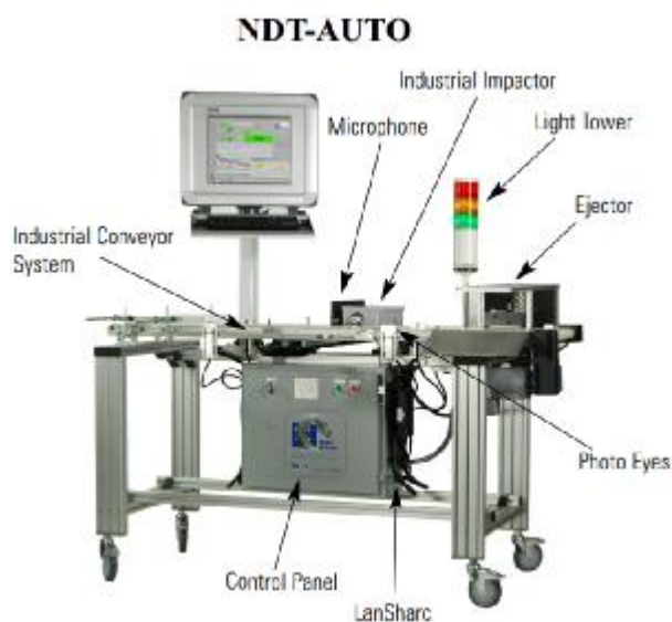
Σχήμα 2.1: Βιομηχανική πειραματική διάταξη επιθεώρησης αντήχησης
