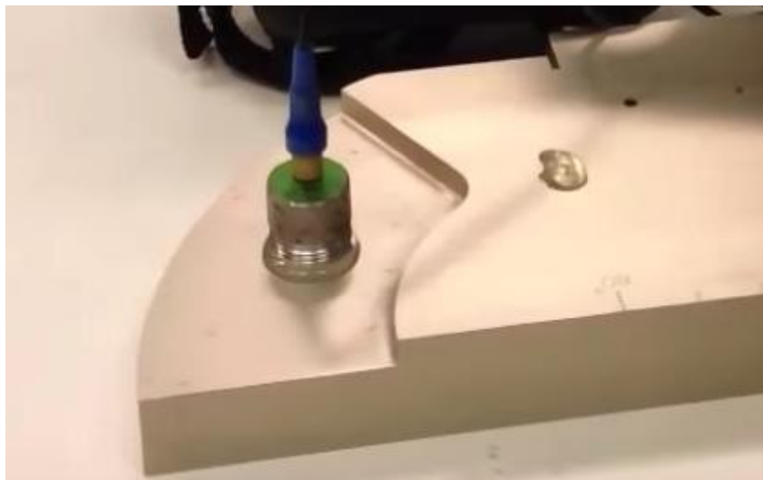
Σχήμα 3.3.2.01: Σύζευξη σε λεπτή επιφάνεια.
