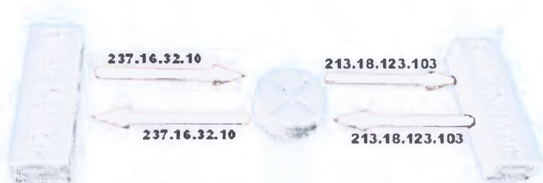
Σχήμα 14. Οι εσωτερικές IP διευθύνσεις (237.16.32.xx) χρησιμοποιούνται επίσης από κάποιο άλλο δίκτυο. Συνεπώς ο δρομολογητής μεταφράζει τις διευθύνσεις προς αποφυγή συγκρούσεων με το άλλο δίκτυο.
