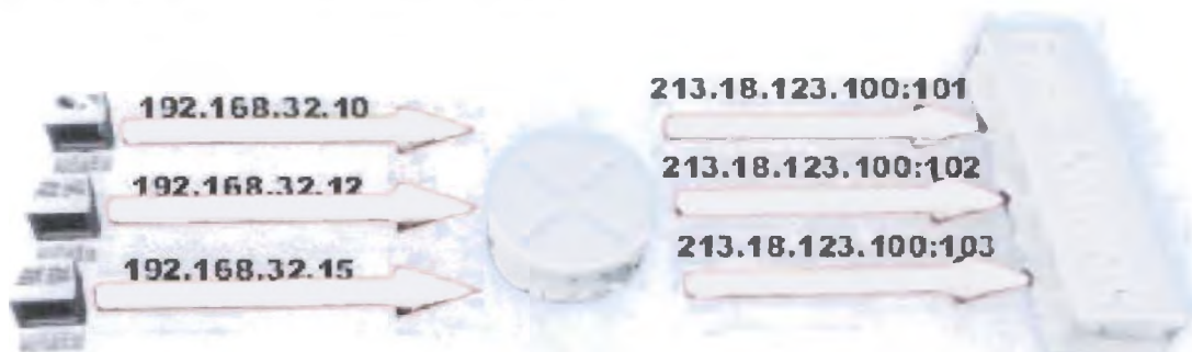
Σχήμα 13. Στο overloading, κάθε υπολογιστής ενός ιδιωτικού δικτύου μεταφράζεται στην ίδια IP διεύθυνση (213.18.123.100) αλλά με διαφορετικό αριθμό θυρών.
