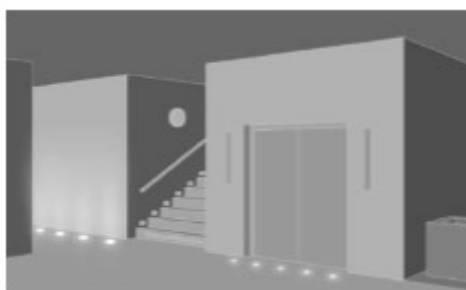
Εικόνα 48: Χωνευτά φωτιστικά πατώματος
