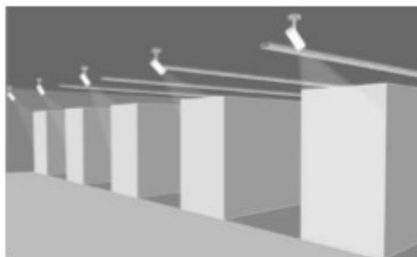
Εικόνα 50: Περιστροφικά / περιστρεφόμενα επιφανειακά τοποθετούμενα φωτιστικά
