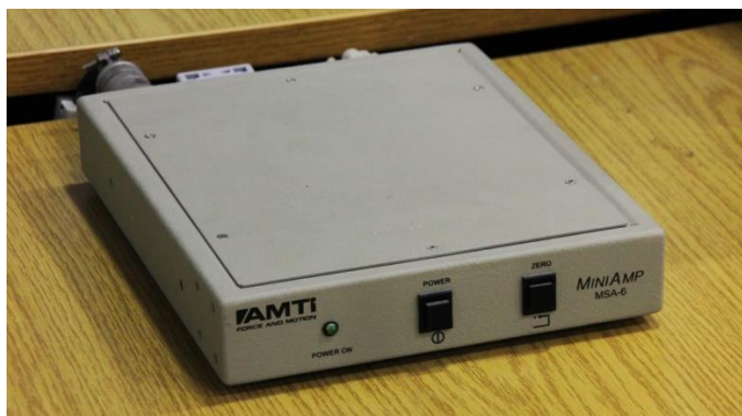
Εικόνα 6.5 AMTI MiniAmp MSA-6 Ενισχυτής και ρυθμιστής δυναμοδαπέδου. Αίθουσα εμβιομηχανικής – Τ.Ε.Ι. Δυτικής Ελλάδας, Παράρτημα Αιγίου.
