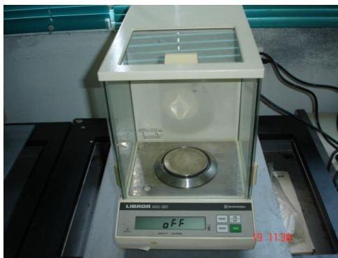
Εικόνα 4. Ζυγός ακριβείας που χρησιμοποιήθηκε στις μετρήσεις των συγκεντρώσεων του \text{NH}_4\text{Cl} και \text{NaNO}_2 (Πηγή: Προσωπικό αρχείο).
