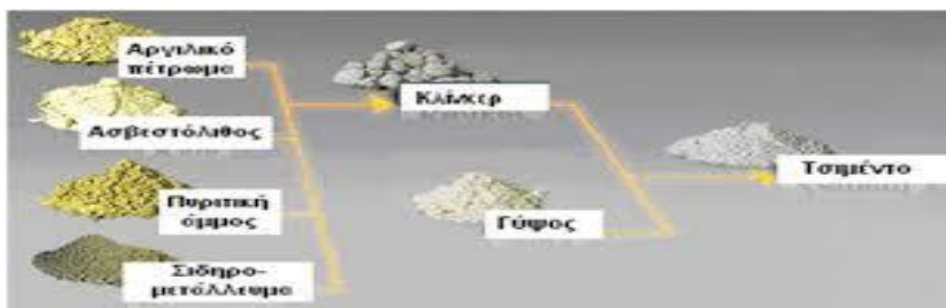
Εικόνα 1.2: Πρώτες ύλες και τελικό προϊόν παραγωγής τσιμέντου [Βιβλιογραφία 23]
