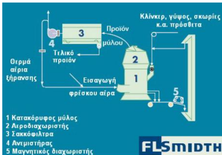
Εικόνα 2.16: Διάταξη άλεσης κλίνκερ με κάθετο μύλο (κατά FLSmidth)
