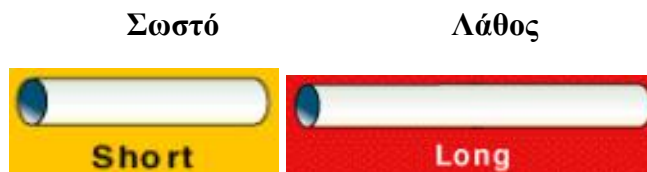
Σχήμα 3.3: Τα μικρά τμήματα έχουν μικρότερη αντίσταση από τα επιμήκη τμήματα.
