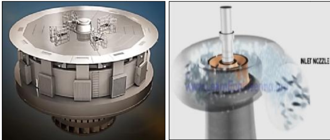
Εικόνα 9 Γεννήτρια υδροστροβίλου - Προσαρμογή άξονα γεννήτριας με το στροφέιο υδροστροβίλου Francis.
