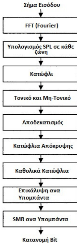
Εικόνα 9 Σχηματικό διάγραμμα ψυχοακουστικού μοντέλου 1
