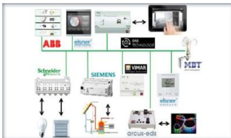
Εικόνα 1.7 : Δια-λειτουργία διαφορετικών κατασκευαστών στο ίδιο έργο KNX.
