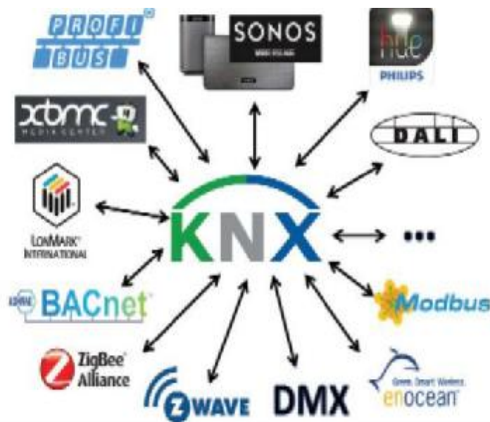
Εικόνα 1.8 : Το KNX σύστημα περιέχει πολλά Gateways για να επικοινωνεί με όλα τα συστήματα.
