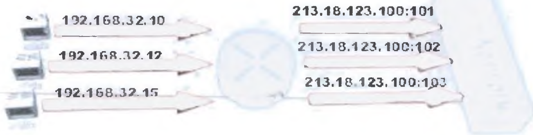
Σχήμα 13. Στο overloading, κάθε υπολογιστής ενός ιδιωτικού δικτύου μεταφράζεται στην ίδια IP διεύθυνση (213.18.123.100) αλλά με διαφορετικό αριθμό θυρών.
