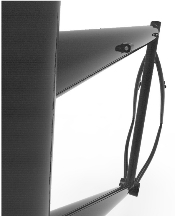
Εικόνα 57. Φωτορεαλιστική απεικόνιση λεπτομέρειας του πλαισίου του ποδηλάτου της εργασίας, όπου απεικονίζονται οι οδηγοί όπου διέρχεται το σύρμα της ντίζας για το πίσω φρένο
