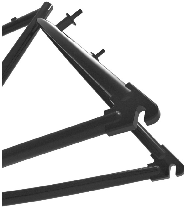
Εικόνα 59. Φωτορεαλιστική απεικόνιση λεπτομέρειας του πλαισίου του ποδηλάτου της εργασίας, όπου απεικονίζονται οι αναμονές για το πίσω τροχό
