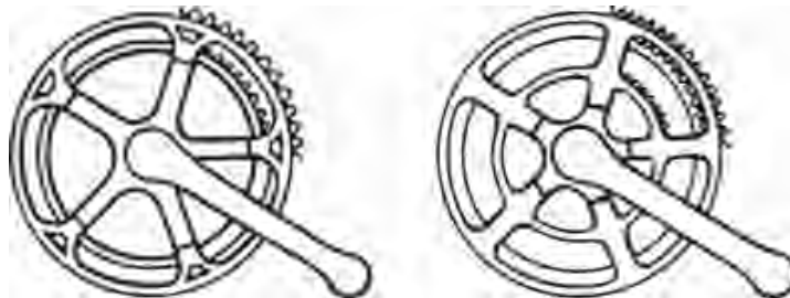
Εικόνα 43. Οι δύο τύποι αλυστροχών
