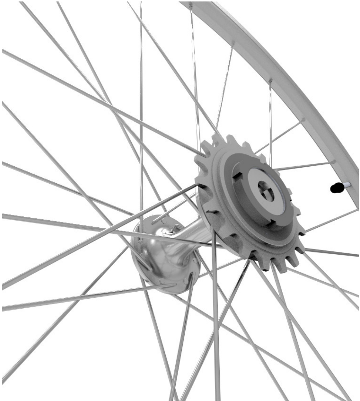
Εικόνα 64. Φωτορεαλιστική απεικόνιση λεπτομέρειας πίσω τροχού (σύνδεση ακτινών στον άξονα)
