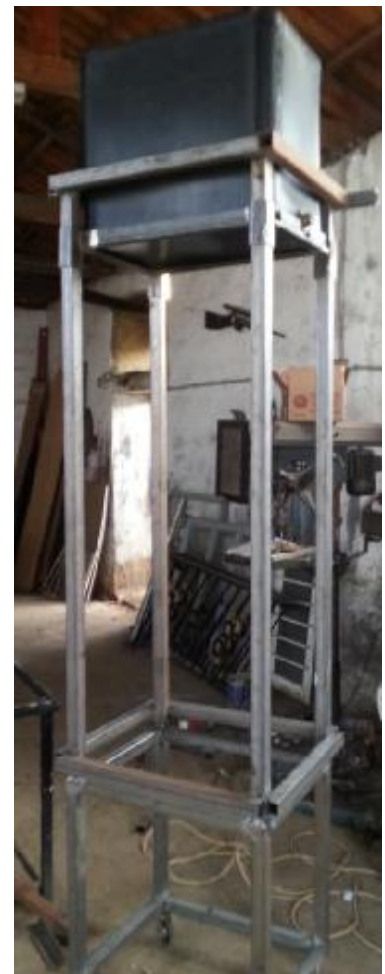
[Εικόνα 5.4α κινούμενη βάση δοχείου με 4τεσσερεις οδηγούς και Εικόνα 5.4.β από την κατασκευή]
