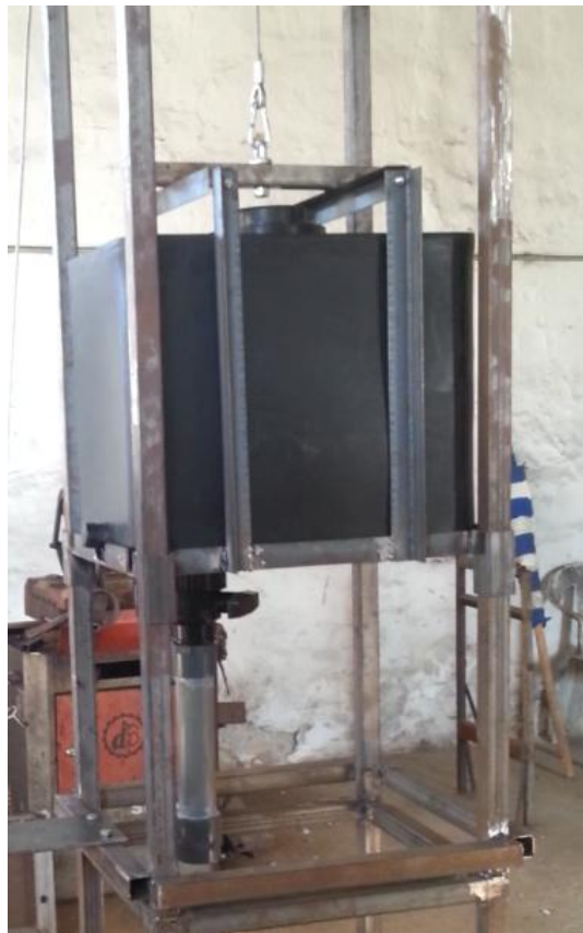
[ Εικόνα 5.4 γ η βάση του δοχείου και η πλάγια κολλημένες γωνίες ]
