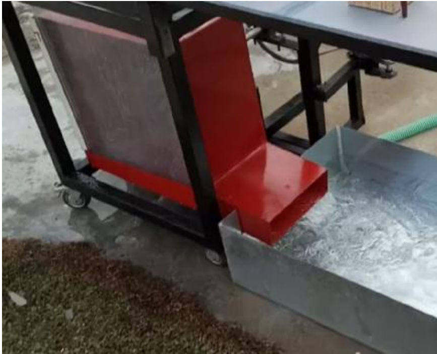
[Εικόνα 5.3.8α κάλυμμά τροχού Pelton ]
