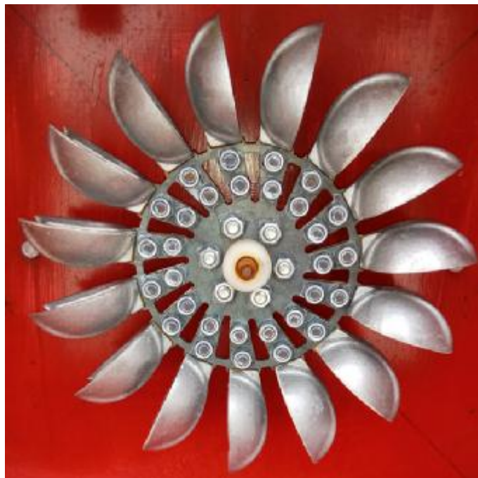
[Εικόνα 5.3.4α τροχός Pelton της κατασκευής]
