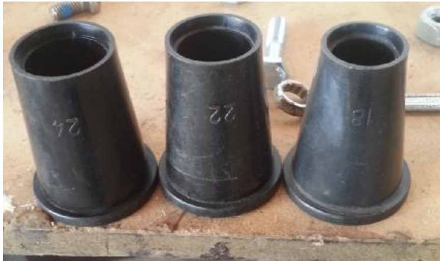
[ Εικόνα 5.3.8γ Ακροφύσια βιδωτά διάφορων μεγεθών ]
