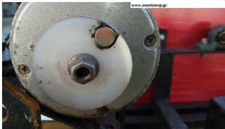
[Εικόνα 5.3.6 Μικρή τροχαλία γεννήτριας ]
