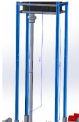
[Εικόνα 5.4α κινούμενη βάση δοχείου με 4τεσσερεις οδηγούς και Εικόνα 5.4.β από την κατασκευή]
