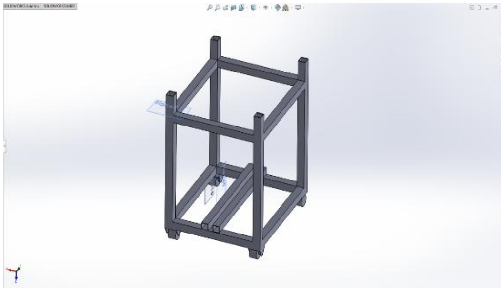
[Εικόνα 5.3α κινητό τραπέζι σχεδιασμένο στο πρόγραμμα SOLID WORKS ]
