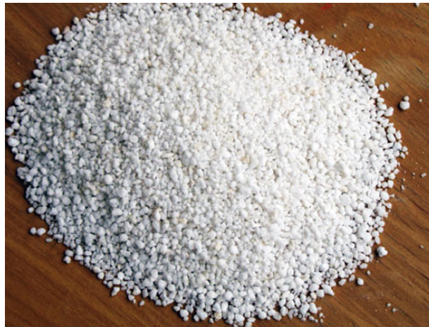
Εικόνα 4. Περλίτης που χρησιμοποιείται στα ενυδρειοπονικά συστήματα για υπόστρωμα στα φυτά (Πηγή: http://www.ergatex.gr )
