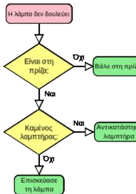
Εικόνα 1 Ένα απλό διάγραμμα ροής, το οποίο απεικονίζει τον αλγόριθμο ελέγχου και επισκευής μιας λάμπας η οποία δεν δουλεύει.
