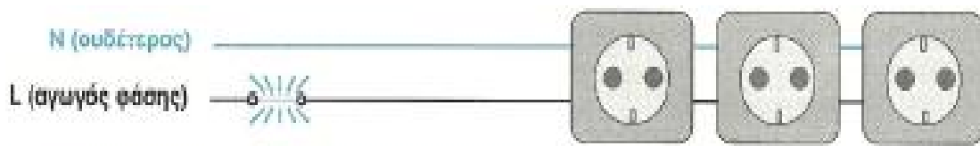
Σχ.4.1.1.α Η ασφάλεια συνδέεται σε σειρά στο κύκλωμα το οποίο προστατεύει.
