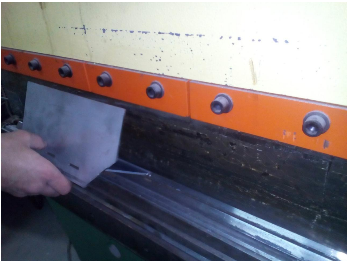
Εικόνα 7.2: Κάμψη τμήματος του καυστήρα
