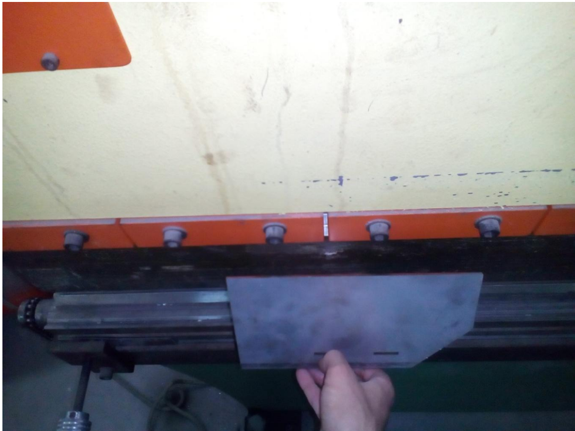
Εικόνα 7.3: Κάμψη τμήματος του καυστήρα
