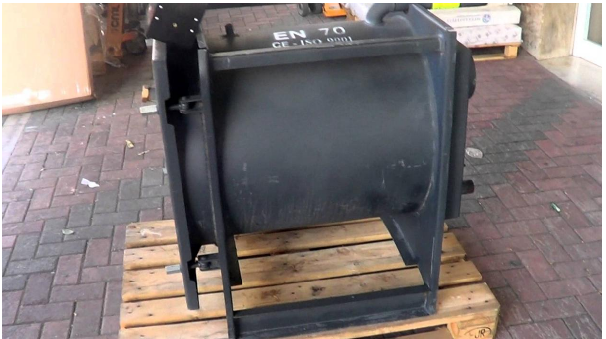
Εικόνα 3.4: Χαλύβδινος λέβητας κατά την φάση της κατασκευής του πριν τοποθετηθεί μόνωση και καλύμματα [9]
