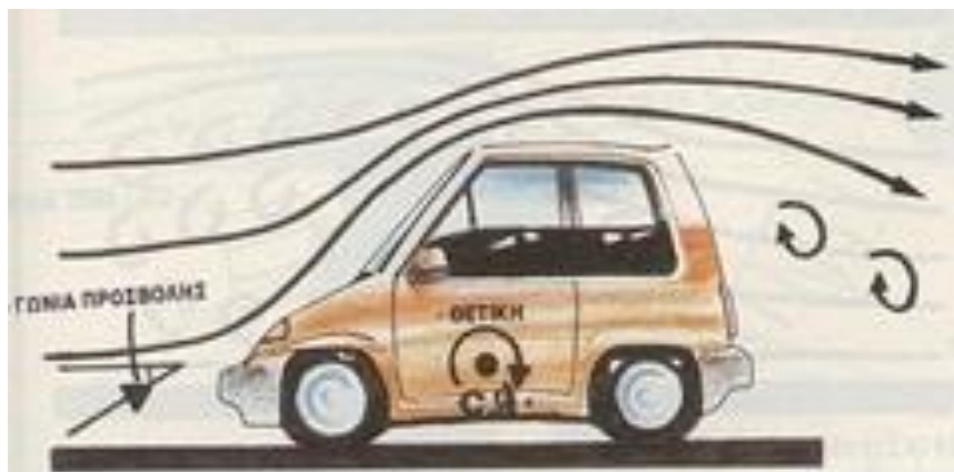
Σχήμα 3.2: Οι τρεις βασικές δυνάμεις που εξασκεί ο αέρας στα αυτοκίνητα [8]
