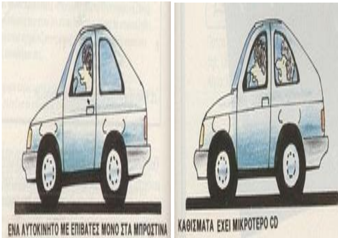
Εικόνα 3.4: Οπισθέλκουσα και χωρητικότητα οχήματος [8]
