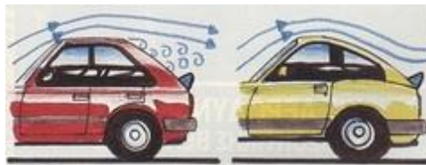
Σχήμα 3.26: Η διακριτικότητα του πίσω σπóιλερ αυξάνει την αποτελεσματικότητά του [8]
