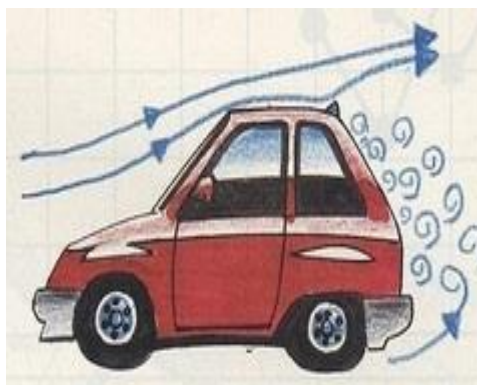
Σχήμα 3.21: Η θαυματουργή προεξοχή της οροφής [8]
