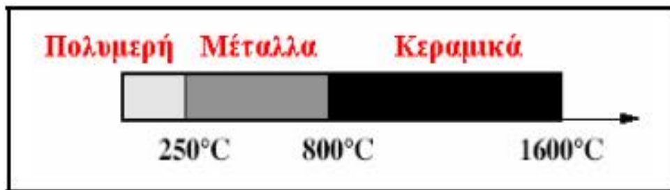
Εικόνα 15: Θερμοκρασιακά όρια χρήσης των υλικών
