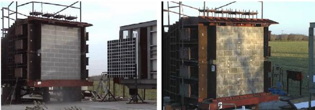
Εικόνα 59:Πειράματα εκρήξεων σε μη ενισχυμένο(αριστερά) και ενισχυμένο (δεξιά) τοίχο
