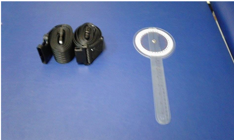
Εικόνα 16: Τα όργανα που χρησιμοποιήθηκαν στη δοκιμασία άρσης τεταμένου σκέλους (SLR test), ιμάντες σταθεροποίησης, γωνιόμετρο
