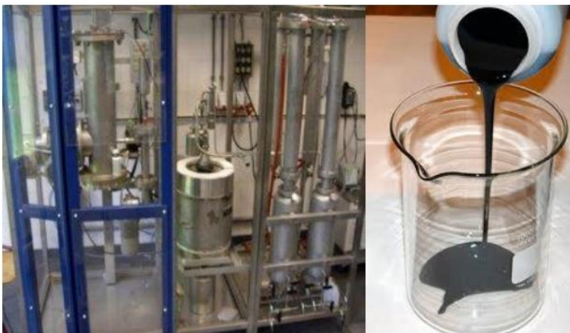
Σχήμα 3.13: Πιλοτική μονάδα ταχείας πυρόλυσης βιομάζας στην Ολλανδία και το προϊόν (έλαιο πυρόλυσης ή βιοέλαιο) [8].
