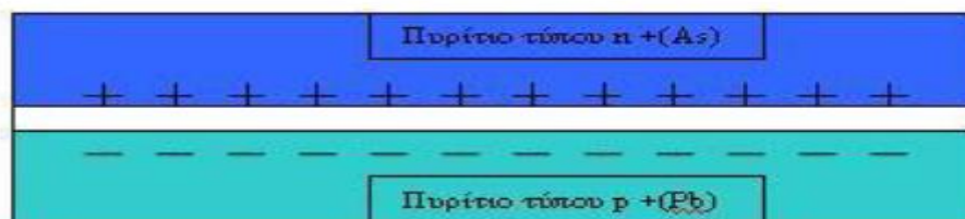
ΕΙΚΟΝΑ 20 : Επαφή ημιαγωγικού στοιχείου τύπου n με ημιαγωγικό στοιχείο τύπου p
