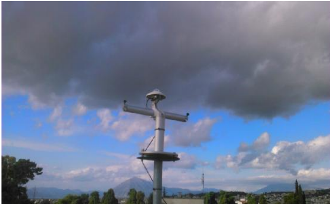
Εικόνα 47: Πυρανόμετρο μέτρησης της άμεσης ηλιακής ακτινοβολίας. [Εργαστήριο Ηλιακής Ενέργειας ΤΕΙ Πάτρας]
