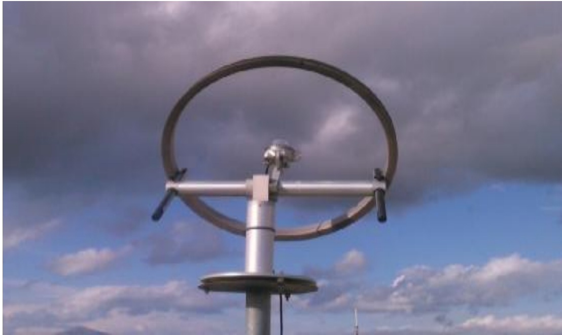
Εικόνα 48: Πυρανόμετρο μέτρησης της διάχυτης ηλιακής ακτινοβολίας. [Εργαστήριο Ηλιακής Ενέργειας ΤΕΙ Πάτρας]
