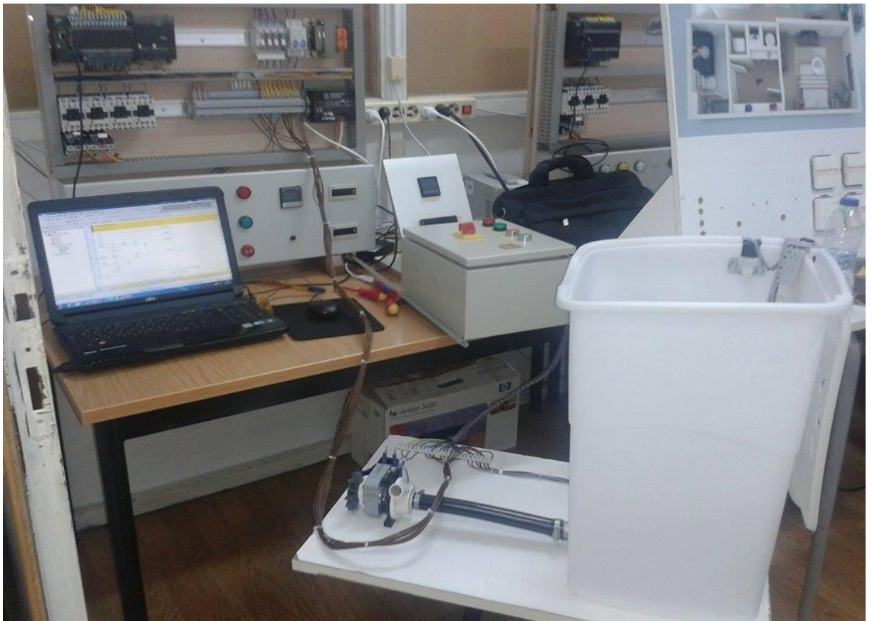
Εικόνα 4.1: Έλεγχος στάθμης νερού και αυτόματη λειτουργία αντλίας
