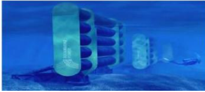
Εικόνα 2.19. Μετατροπείς Oyster™ φυσικής κλίμακας στο βυθό της θάλασσας.
