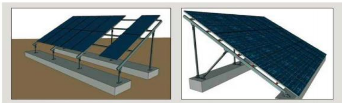
Εικόνα 25:Σκυροδέτηση σταθερών βάσεων σε δοκάρια από μπετόν
