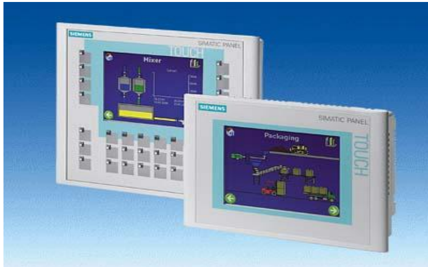
Σχήμα 1.17: Οθόνη τύπου Operator Panel
