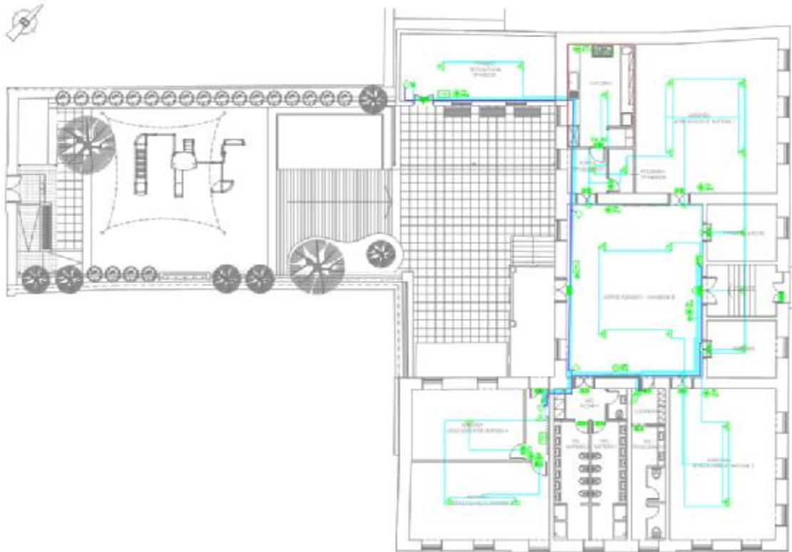
Εικόνα 7.2: Σχέδιο Πυρασφάλεια (Κάτοψη Ισογείου – Αυλής)
