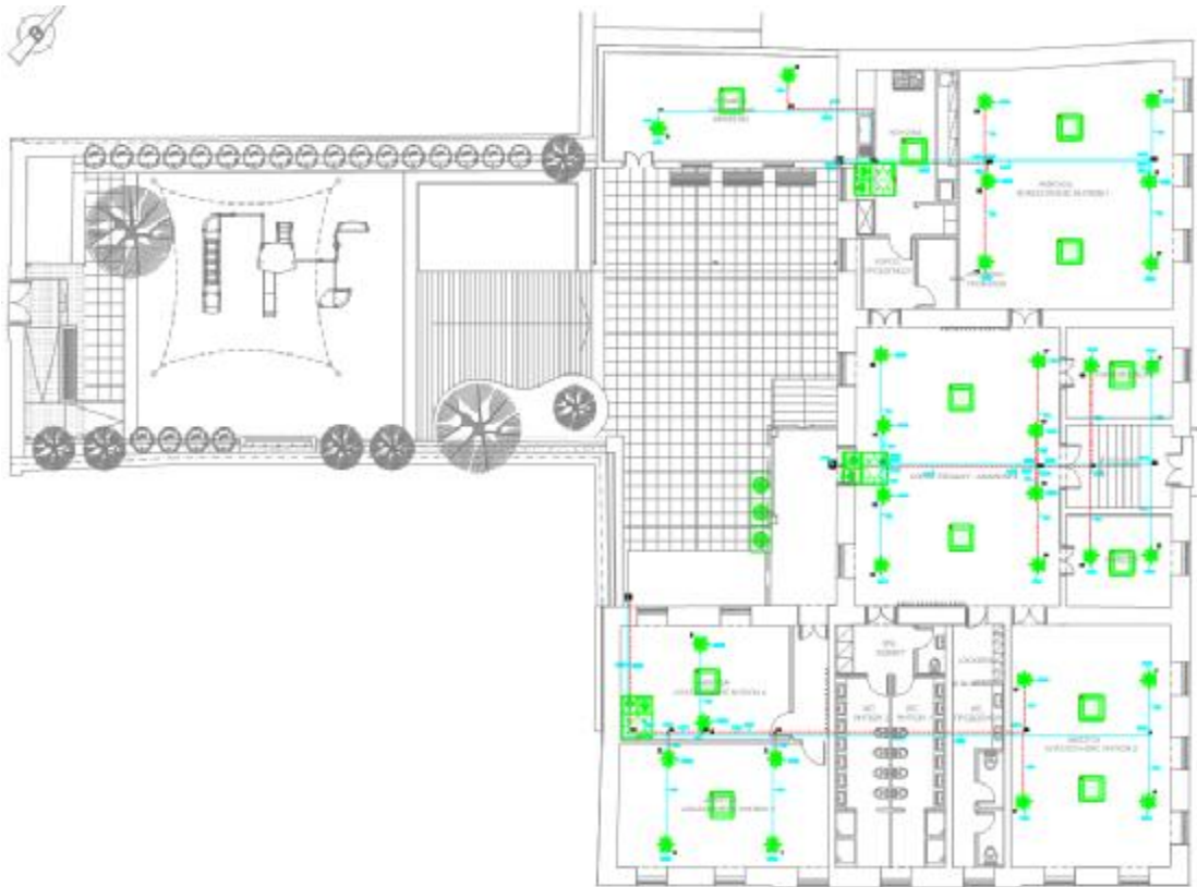
Εικόνα 5.1: Σχέδιο Κλιματισμού – Θέρμανσης (Κάτοψη Ισογείου – Αυλής)
