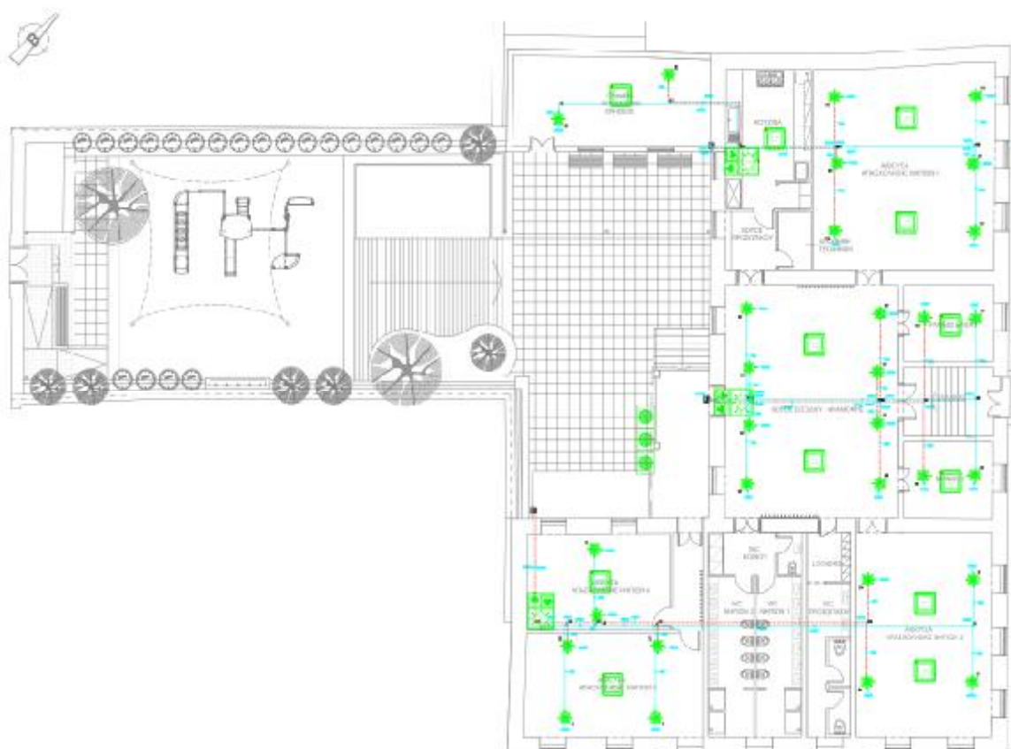
Εικόνα 6.1: Σχέδιο Συστήματος Αερισμού (Κάτοψη Ισογείου – Αυλής)
