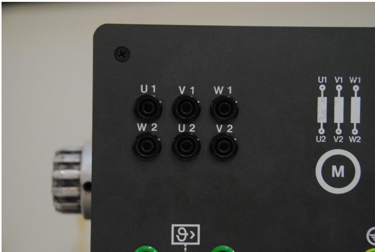
Εικόνα 1-2: Κοντινή άποψη ακροδεκτών ενός επαγωγικού κινητήρα
