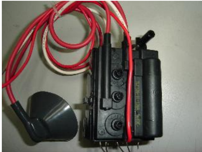
Εικόνα 4.6: Μετασχηματιστής υψηλής τάσης
