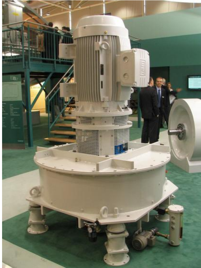
Εικόνα 3.12: Μια μηχανή flywheel (εξωτερική άποψη)
