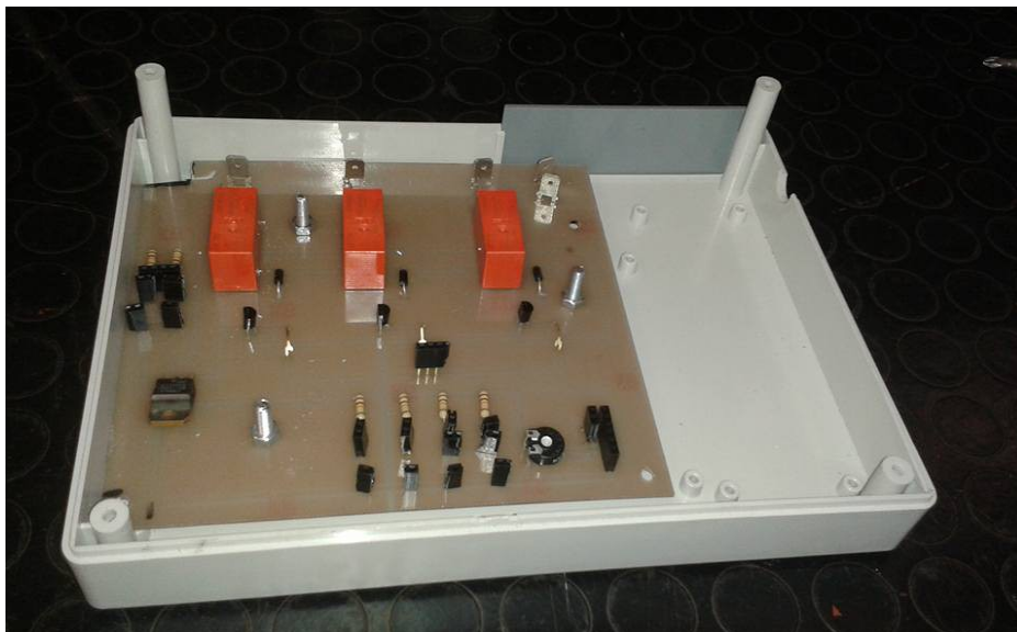
Εικόνα 6: Τοποθέτηση πλακέτας στο κουτί κατασκευής
