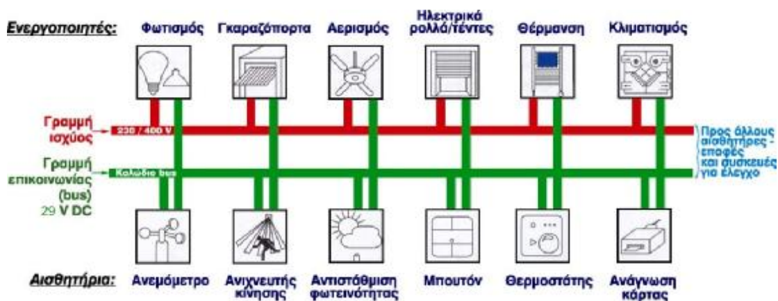
Εικόνα 1.2 : Συνδεσμολογία ενός συστήματος KNX TP1.
