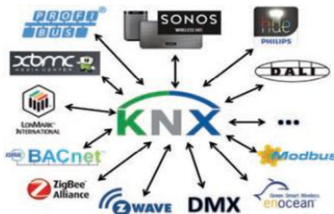
Εικόνα 1.5: Το KNX σύστημα περιέχει πολλά Gateways για όλα τα συστήματα.
