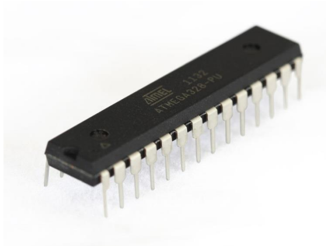
Εικόνα 3: Μικροελεγκτής AT mega 328 [3]
