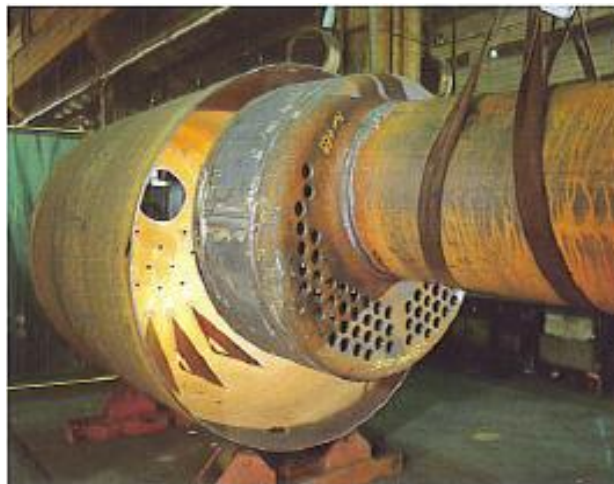
Εικόνα 1.4: Βιομηχανικός αεριαλωτός ατμολέβητας στη φάση της κατασκευής (μοντάρισμα θαλάμου καύσης με το εξωτερικό κυλινδρικό σώμα)
