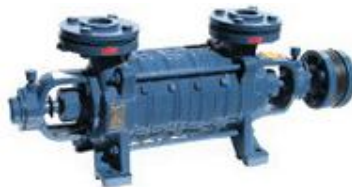
Εικόνα 16: Αντλία νερού τροφοδοσίας
