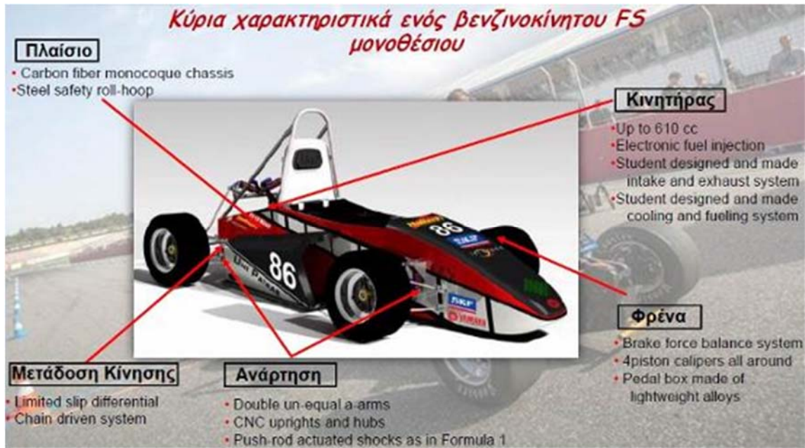
Εικόνα 1.6: Τα κύρια χαρακτηριστικά ενός βενζινοκίνητου μονοθέσιου.
