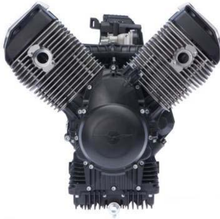
Εικόνα 2.2: Κορμός 2-κύλινδρου σε διάταξη V κινητήρα μοτοσυκλέτας.
