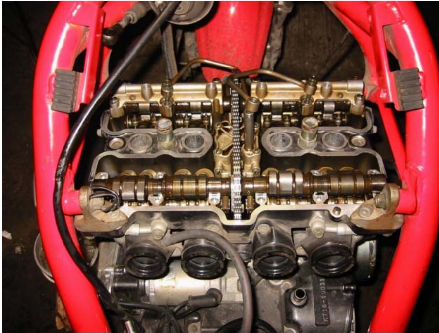
Εικόνα 2.33: Εκκεντροφόρος εισαγωγής τετρακύλινδρου κινητήρα δυο διαφορετικά προφίλ για μεταβαλλόμενο βύθισμα και διάρκεια βαλβίδων.
