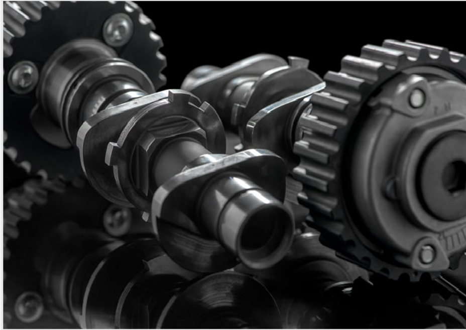
Εικόνα 2.36: Σύστημα Desmodromic Variable Timing της Ducati.
