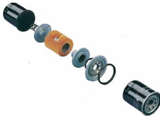
Εικόνα 3.6: Δομή φίλτρου λαδιού.
