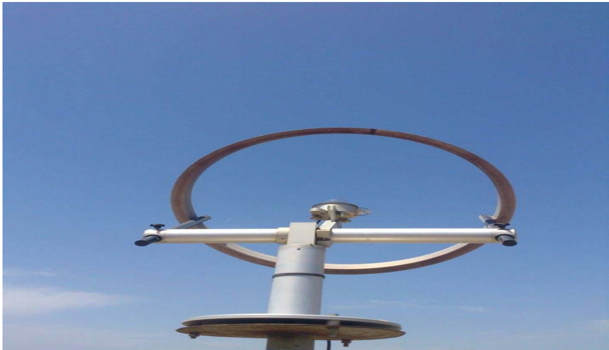
Εικόνα 1.22: Πυρανόμετρο με στεφάνι τοποθετημένο στο εργαστήριο των ΑΠΕ, ΤΕΙ Δυτικής Ελλάδας
