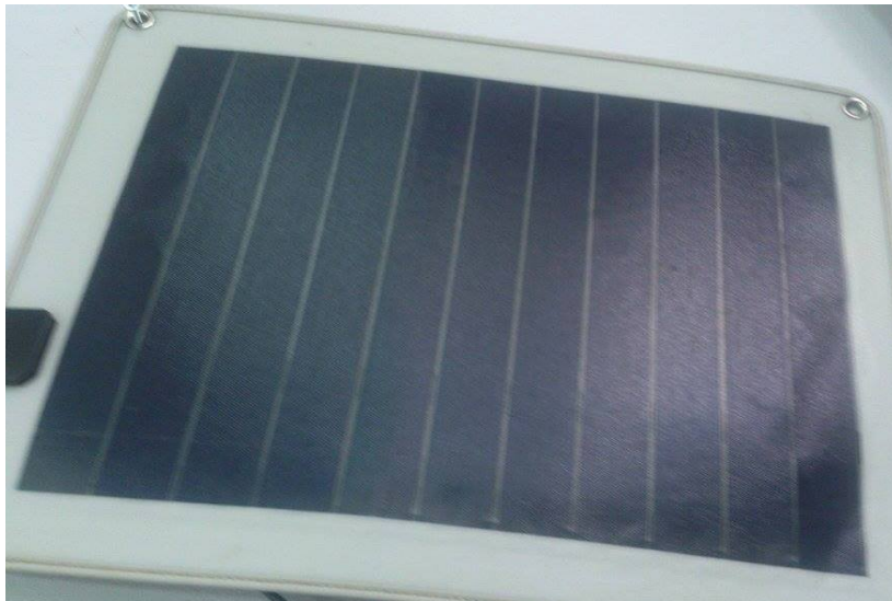
Εικόνα 2.18: Φωτοβολταϊκό στοιχείο thin film στο εργαστήριο των ΑΠΕ ΤΕΙ Δυτικής Ελλάδας
