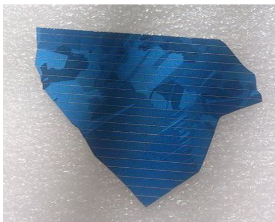
Εικόνα 2.16: Στοιχείο μονοκρυσταλλικού πυρίτιου στο εργαστήριο των ΑΠΕ ΤΕΙ Δυτικής Ελλάδας
