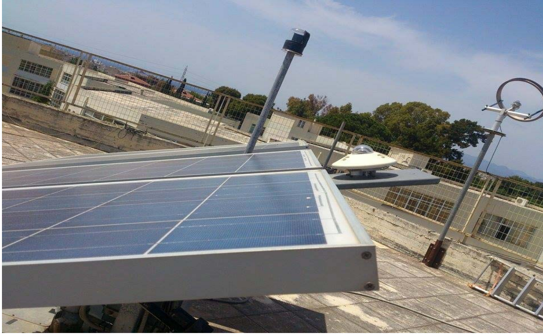
Εικόνα 4.4: Πυρανόμετρο τοποθετημένο στην σταθερή φωτοβολταϊκή γεννήτρια (Tracker) στο εργαστήριο των ΑΠΕ, ΤΕΙ Δυτικής Ελλάδας
