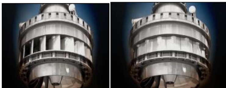
Εικόνα 48 Ομοίωμα οδηγού πτερύγωσης σε στρόβιλο Francis(ανοικτή- κλειστή θέση) [πηγή: Ένεργο-24]
