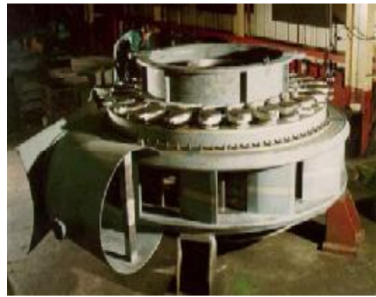
Εικόνα 50 α) Τοποθέτηση δρομέα β) Κατασκευή τμημάτων Υδροστροβίλου Francis [πηγή: Steam Turbine Impulse and Reaction]
