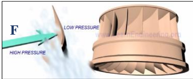
Εικόνα 72 Η διαφορά πίεσης είναι υπεύθυνη για τον σχηματισμό μιας δύναμης (F) και κατά συνέπεια περιστροφή του στροφείου, όπως και η διαφορά πίεσης για την ανάπτυξη σηηλαίωσης. [πηγή: learn engineering, www.youtube.com/watch?v=3BCiFeykRzo]
