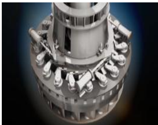
Εικόνα 49. α) Σύστημα κίνησης κινητών πτερυγίων, β) τοποθέτηση κινητών πτερυγίων σε ΥΗΣ [πηγή: Θαέρσο-24 , , Steam Turbine Impulse and Reaction ]
