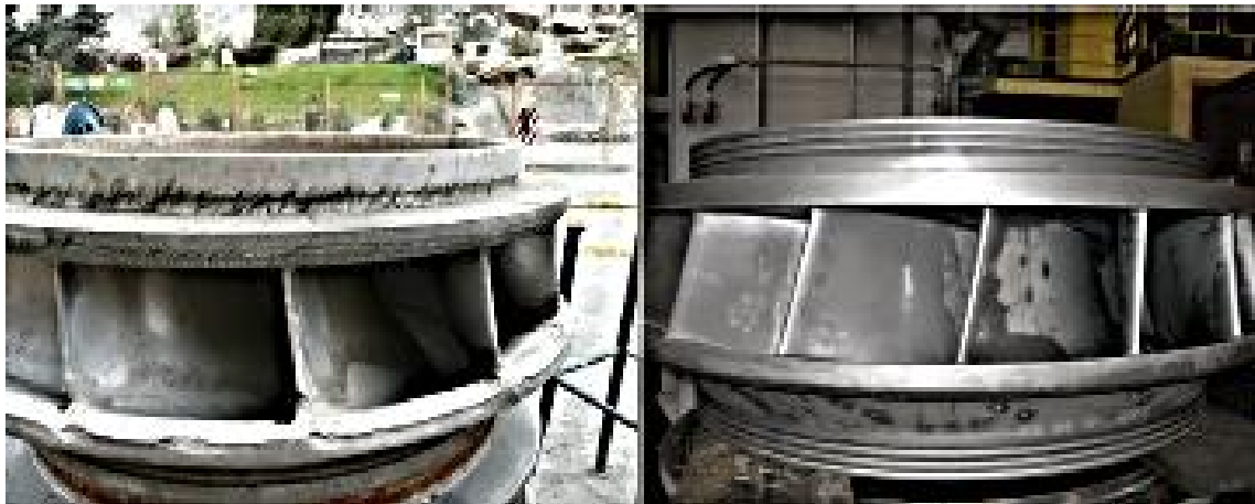
Εικόνα 57 (α) παραδοσιακό στροφέιο (β) x-blade [πηγή: cgyunhe.com/Products/tabid/135 ]
