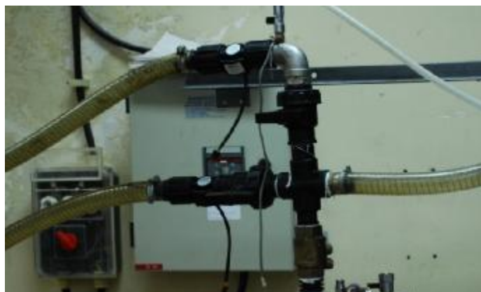
Εικόνα 3.9 Σύστημα ρυθμιζόμενης διανομής της ροής στους δύο διαφορετικούς κλάδους του κυκλώματος, στένωση και αναστόμωση.
