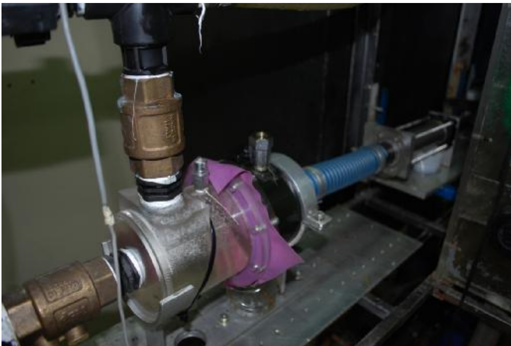
Εικόνα 3.12 Σύστημα παλμικής αντλίας
