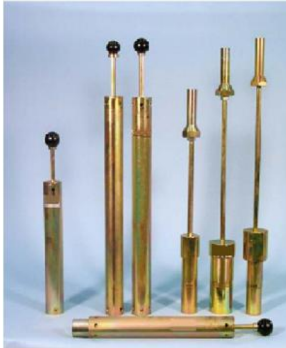
Εικόνα 5.4: Λεπτομέρεια διάταξης για τον προσδιορισμό συμπύκνωσης
