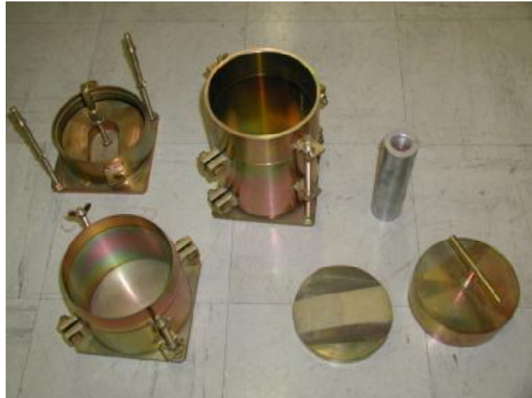
Εικόνα 5.7: Εξοπλισμός για τις δοκιμές CBR. Κάτω αριστερά διακρίνεται η κοψέλη για την δοκιμή αντοχής CBR.
