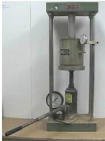
Εικόνα 5.6: Εργαστηριακή διάταξη για την δοκιμή CBR για χρήση σε εργοτάξιο
