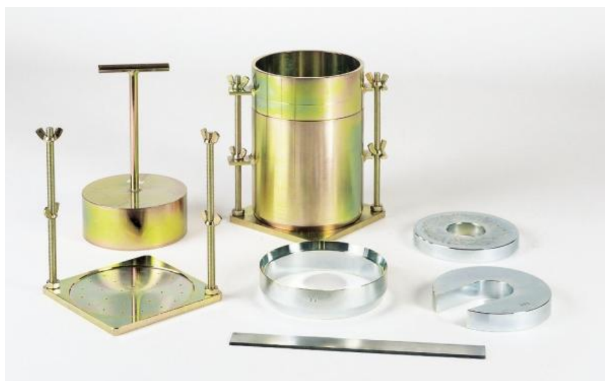
Εικόνα 5.11: Εξοπλισμός για τη δοκιμή CBR
