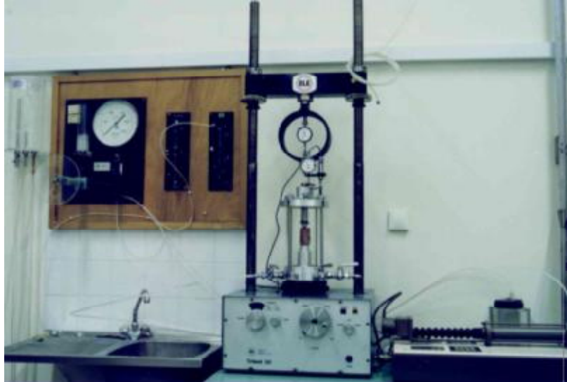
Εικόνα 4.13: Διάταξη τριαξονικής δοκιμής, κυψέλη + συστήματα πίεσης
