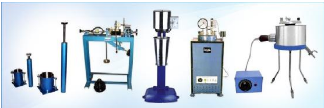
Εικόνα 3.2: Διατάξεις για τον προσδιορισμό της στερεοποίησης
