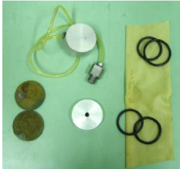
Εικόνα 4.14: Εξοπλισμός για την τριαξονική δοκιμή: Πωρόλιθοι, διάτρητες πλάκες φόρτισης, υδατοστεγής μεμβράνη, λαστιχάκια στεγανοποίησης
