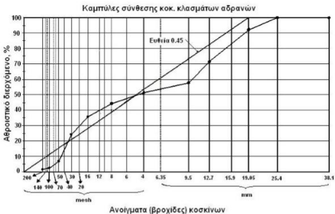
Σχήμα 7.13. Μη αποδεκτή καμπύλη (τύπου 0.45) κοκκομετρικής σύνθεσης αδρανών μέγιστου τεμαχίου 25 mm.
