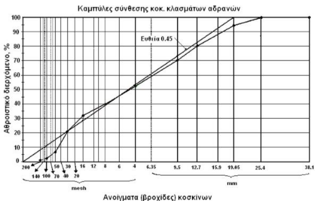
Σχήμα 7.12. Αποδεκτή καμπύλη (τύπου 0.45) κοκκομετρικής σύνθεσης αδρανών μέγιστου τεμαχίου 25 mm.
