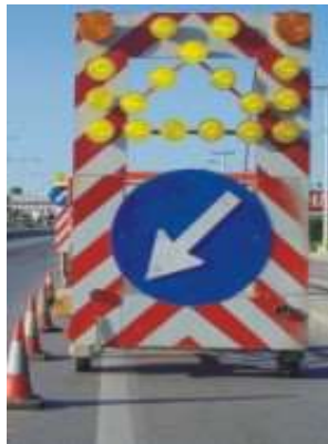
Εικόνα 17: Κινητή μονάδα σήμανσης
