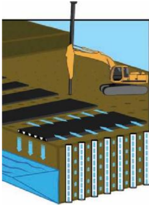
Εικόνα 3. Σχηματική διάταξη και τρόπος λειτουργίας των κατακόρυφων συνθετικών στραγγιστηρίων. Η αυξημένη οριζόντια διαπερατότητα και η μικρή απόσταση μεταξύ των πασσάλων περιορίζουν σημαντικά το χρόνο στερεοποίησης.[2]
