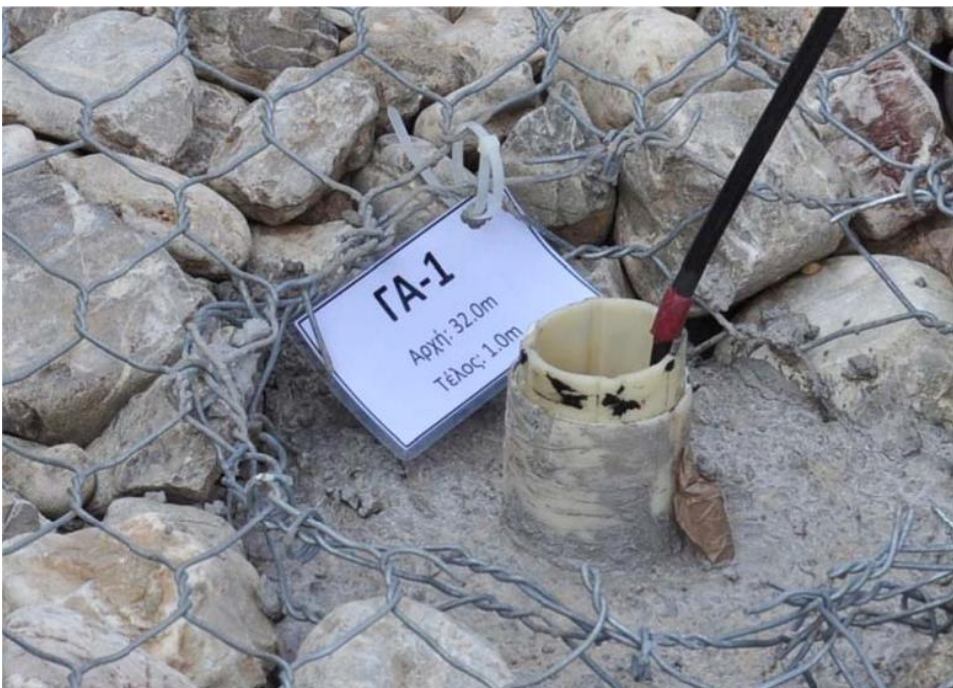
Εικόνα 6.1.5 Αποκλισιομετρικός σωλήνας σημειωμένος με μαρκαδόρο για τον προσανατολισμό της τορπίλης
