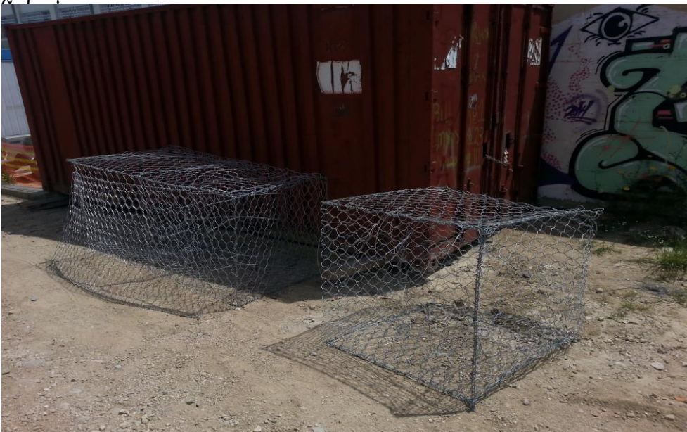
Εικόνα 3.6 Προκατασκευασμένα συρματοκιβώτια σαραζανέτ.
