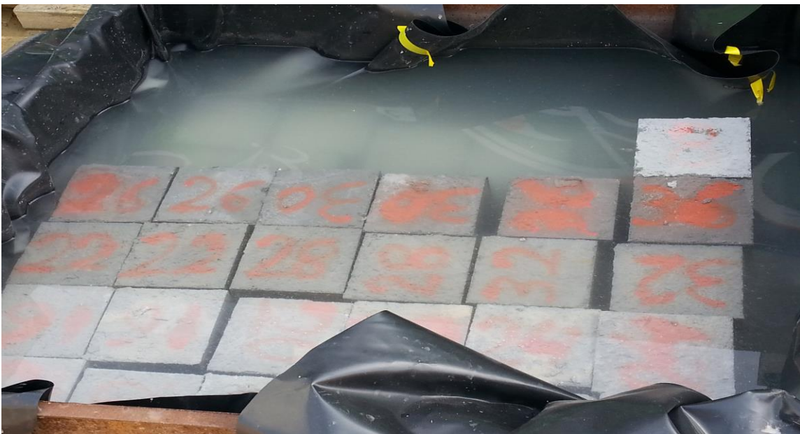
Εικόνα 4.11 Δείγμα δοκιμίων που πάρθηκαν κατά τη σκυροδέτηση. Συντηρούνται στο νερό μέχρι να μεταφερθούν στο εργαστήριο ποιοτικού ελέγχου.
