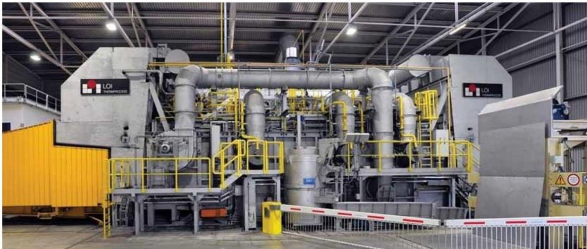
Εικόνα 8: Τήξη και εξευγενισμός παλαιών τεμαχίων αλουμινίου
